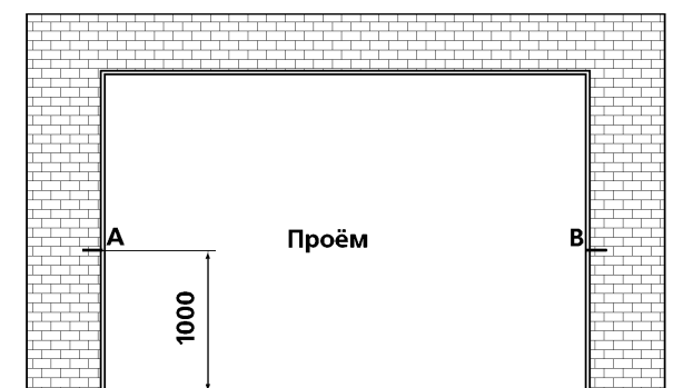
Рис.3. Нанесение установочных меток.
