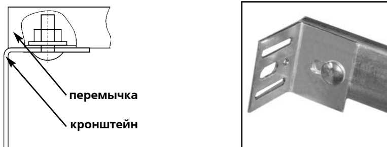
Рис. 13. Крепление кронштейна к перемычке.
